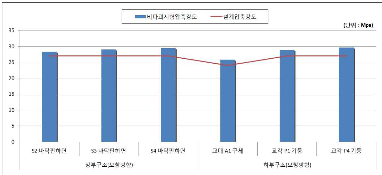
【그림 2.4.12】 콘크리트 강도시험 결과 그래프
